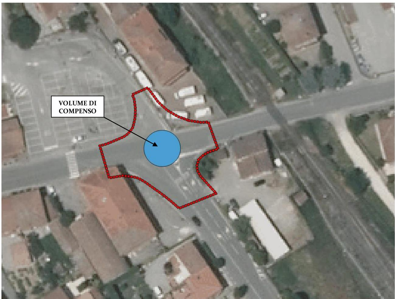
**Fig. 7.6-** Progetto preliminare di messa in sicurezza dell'area dell'intervento: in rosso il limite e in blu l'area di espansione idraulica per la messa in sicurezza
