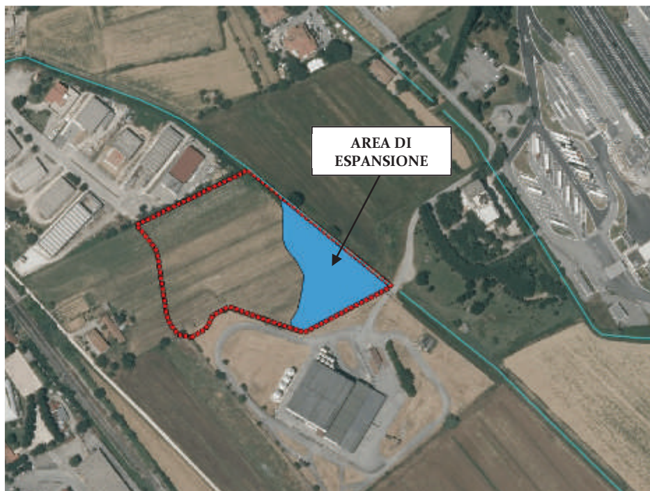
Fig. 7.4- Progetto preliminare di messa in sicurezza dell'area dell'intervento: in rosso il limite e in blu l'area di espansione idraulica per la messa in sicurezza
