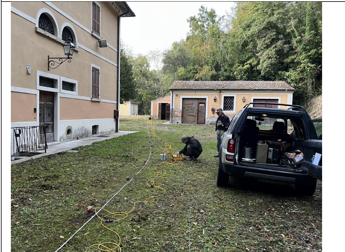
S.R.2 - Sismica a rifrazione e masw – nella parte retrostante della Villa
